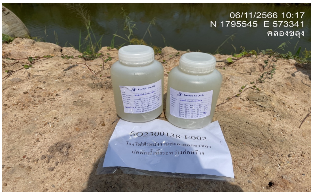
รูปที่ 3.4.3-5 การตรวจวัดคุณภาพน้ำในบ่อพักน้ำทิ้งระยะก่อสร้าง
